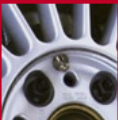
Ventil in die Radnabe integriert
